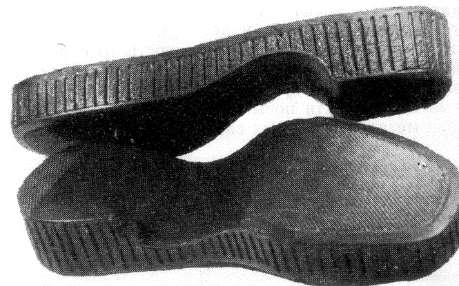
Рис. 123. Пластмассовые изделия, полученные в литой пресс-форме с орнаментом.
